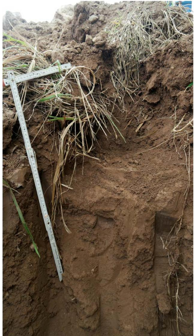
Abbildung 7: Baugrubenböschung im Hochflutlehm (Proben 1 und 2) (Foto: Kerth).
