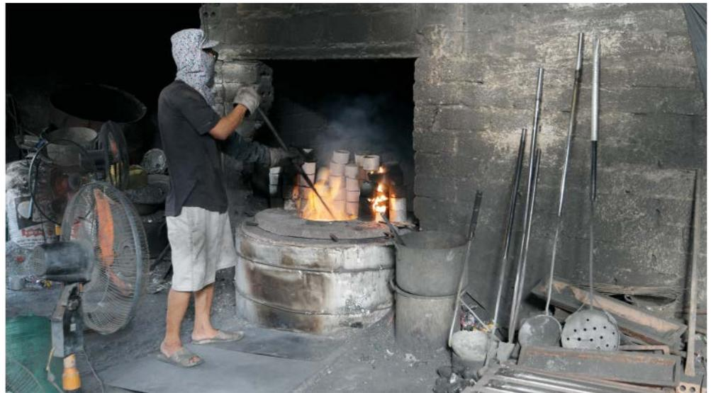
Abbildung 10: Schmelzofen für Aluminiumdosen im Handwerkerdorf (Foto: Kerth).
