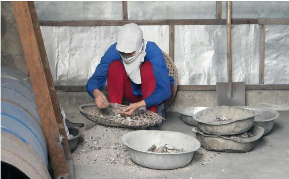
Abbildung 13: Händische Schlackenaufbereitung (Heraussammeln von stark metallhaltigen Schlackenbestandteilen)
